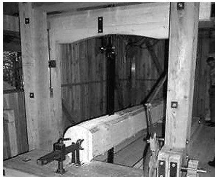
Ein Stamm wird gesägt. Gatter mit Sägeblatt, Wagen mit Befestigungsvorrichtung und Vorschub.
